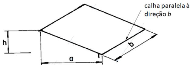
Nesse telhado, a altura *h* da cumeeira é de 1,8 m, e as dimensões *a* e *b* valem, respectivamente, 6 m e 10 m. Sabendo que a intensidade pluviométrica na região vale 200 mm/h, a vazão de projeto a ser considerada no projeto da calha é:
