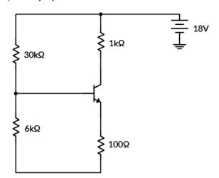
Sendo a corrente de base igual a 100 mA, a tensão  $V_{\text{BE}}$  = 0,7 V e considerando  $I_E$  aproximadamente igual a  $I_C$ , o ganho de corrente na configuração emissor comum desse transistor é:
