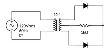
Considerando o diodo de silício (V  $\gamma$  = 0,7 V),  $\sqrt{2}$  = 1,41,  $\pi$  = 3,14, a corrente média na carga alimentada é igual a:
