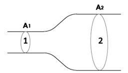
No tubo de seção variável, o fluido atravessa a área 1 e sai pela área 2. Na área 1, o fluido se desloca com velocidade de 15 m/s e seu valor é de 8 é de 8 cm<sup>2</sup>. A área 2 possui 24 cm<sup>2</sup>. O valor da velocidade do fluido que atravessa a área 2 é igual a:
